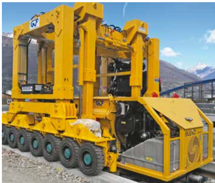
14. Il carro a ponte e l'elemento miscelatore per velocizzare le operazioni di getto in galleria
