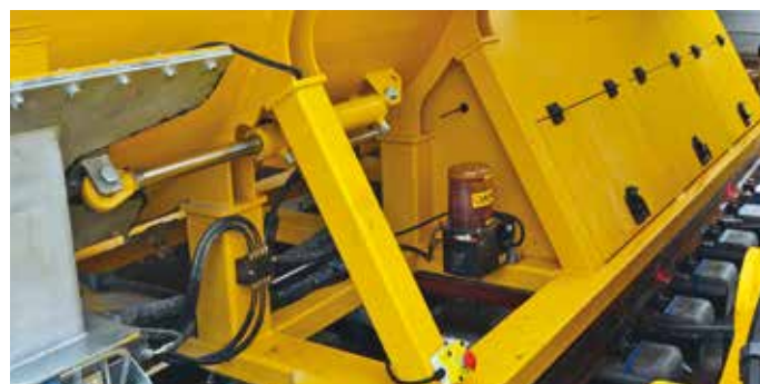
18. Un pistone idraulico in grado di regolare, con serrande, il flusso indipendentemente a seconda delle esigenze del getto
